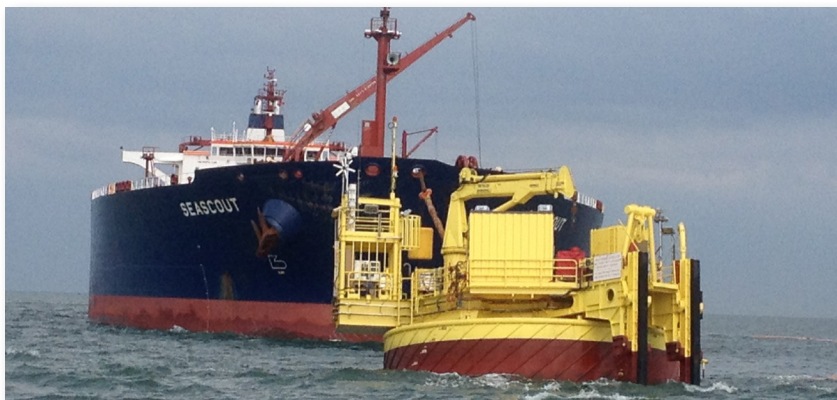
Tetney Monobuoy de Phillips 66, ubicada en el estuario de Humber, R.U.
